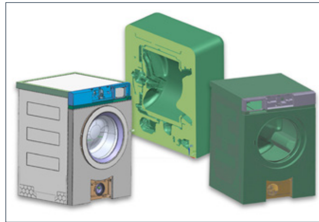
Struktur- und Luftmodell, abgeleitet aus dem CAD Modell und gekoppelt für das Vibroakustikmodell. (unten)
