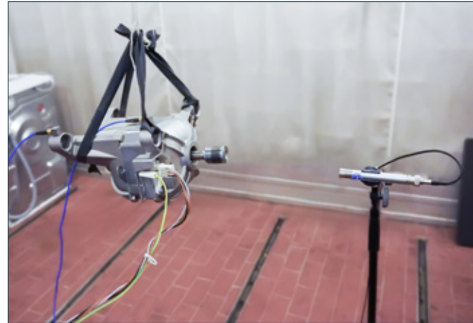
Messung von Systemanregungen durch den Motor (Schwingungen und Schall) für das Simulationsmodell.
