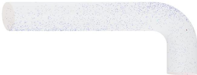
**Abbildung 3:** Momentaufnahme der Partikelverteilung innerhalb eines Rohrsegments bei einer Geschwindigkeit von 20m/s und einer Partikelbeladung von 0.2kg/s.
