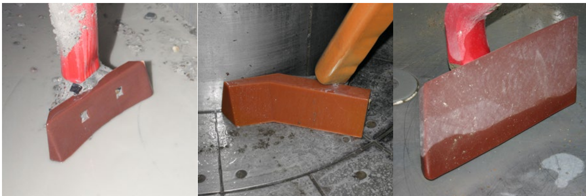
Abbildung 4.15: Verschiedene Geometrien für Abstreifer. Quelle: www.rwev.de
