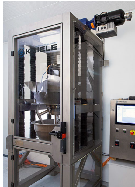
Abbildung 4.5: Labormischer KKM –RT 15/22,5 der Kniele GmbH
