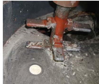
Abbildung 4.14: In den Boden eines Betonmischers eingelassene Mikrowellensonde
